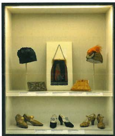
Abb. links: In Schaukästen werden Accessoires gezeigt. Eine Nut in der oberen Abdeckung und im Zwischenboden nimmt jeweils Lichtauslässe eines Lichtleitfaser-Systems auf. (© Lichtvision, Thomas Müller)
