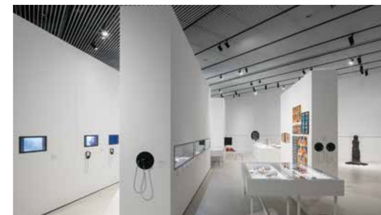
Abb. oben: Mit transluzenten Glasscheiben versehene Stahlrahmen bilden in der Dauerausstellung Grimm 1 und 2 Nischen und Gänge. Dazwischen abgependelte Stromschielen mit schwarzen »Palco C.o.B.« Strahlern betonen Textgrafiken, Wände oder Exponate.
